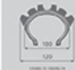
La largeur des pneus Cross est mesurée au niveau de la base des crampons, alors que celle des pneus Enduro est mesurée en «hors tout», c'est-à-dire à l'endroit le plus large, soit au sommet des crampons.
